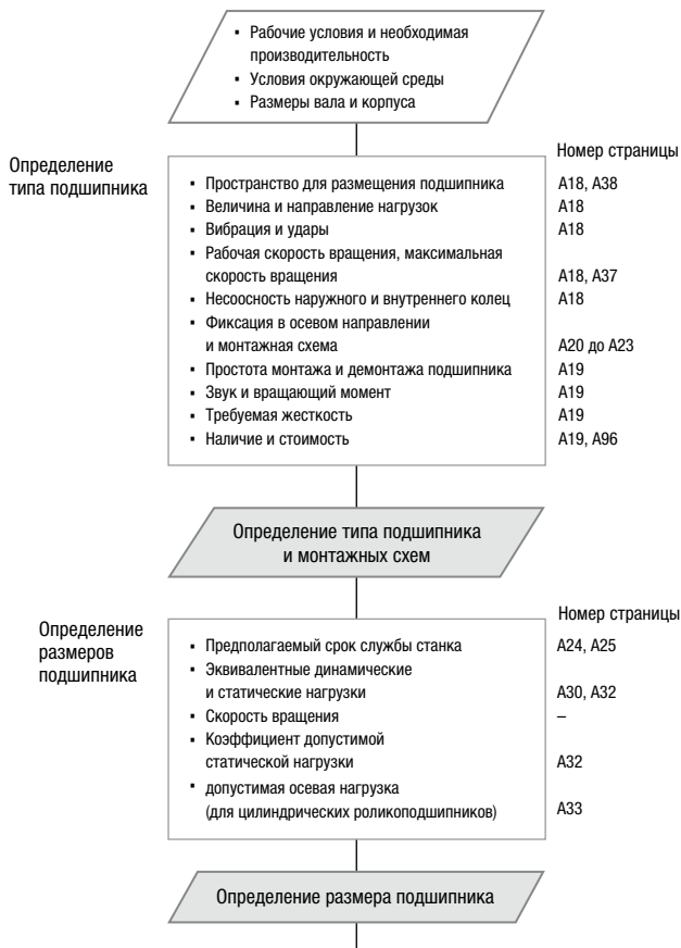
Рисунок 2.1. Схема подбора подшипников качения
