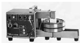
Индукционный нагреватель для подшипников (кат. E398)
